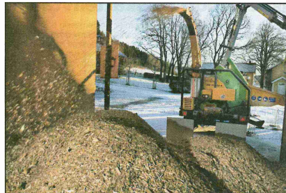
KUTTER FLIS: Gården Eidsalm på Hadeland er et bioenergi maskinbruk. Denne maskinen kutter i løpet av 20 minutter opp flis nok til å varme opp en enebolig i ett år.
