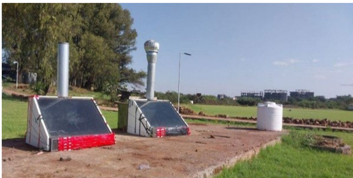
Sol- og vinddrevet passiv fordampner designet for å omdanne urin til fast gjødsel. Foto: Eshetu Adamu
