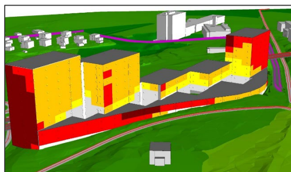
Figur 30. Fasadenivå ( L_{den} ) på PKI-bygget i planalternativ 2A mot sykehusområdet.
