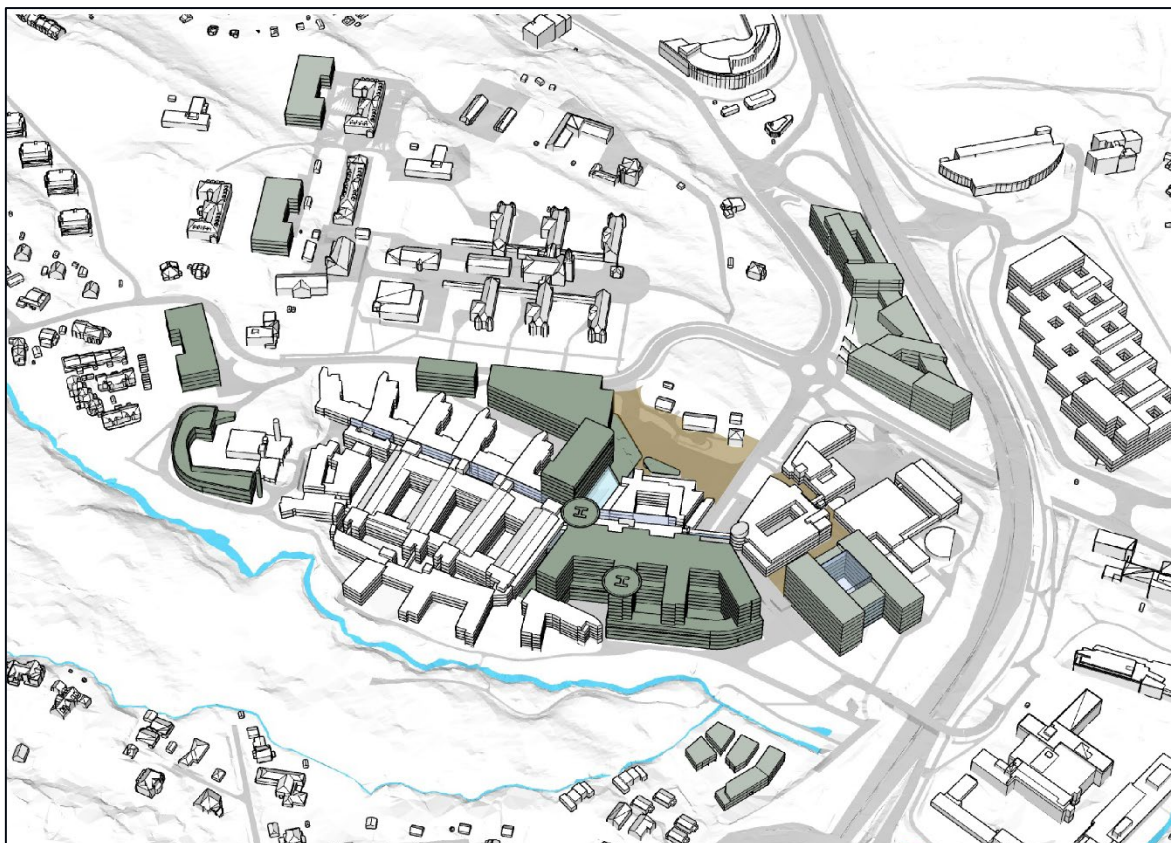
Figur 7. Volumstudie. Mørkegrønne volumer er arealer for etappe 1, lysegrønne volumer er arealer avsatt for utvikling i etappe 2. Nytt atkomststorg er markert i brun. Planalternativ 1B (himmelretning mot øst).
