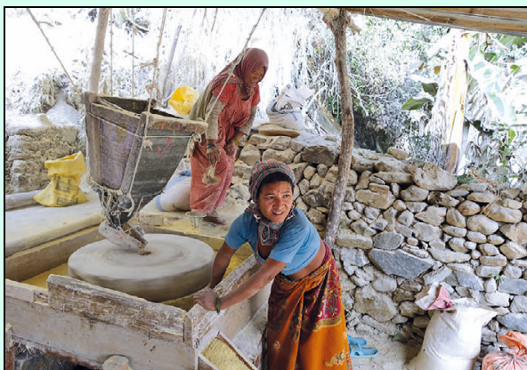
Figur 5.4 Nepal. En kvinne maler mais med kraft av vannmølle, drevet av overskuddsvann fra et mikrokraftverk finansiert av NRREP.
