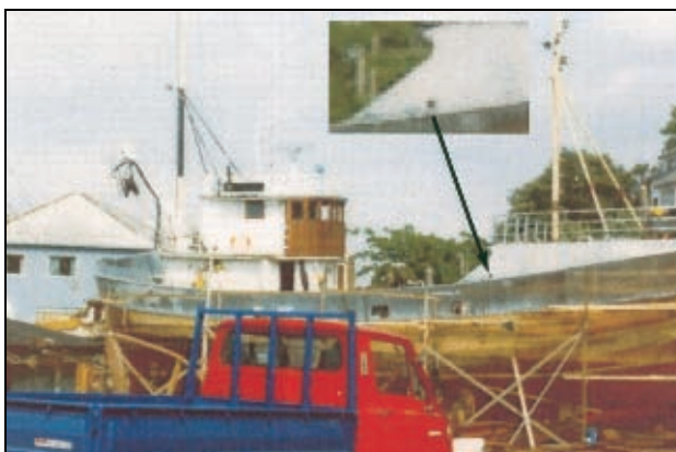
Figur 6.13 Fotografi av "Western" under ombygging til trålbakk. Utklipp av trålbakk
