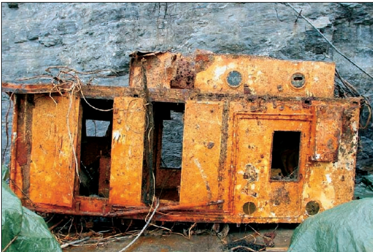
Figur 6.44 Casingen. Babord side. Fra venstre mot høyre ses byssa, gangen og kapteinslugaren.
