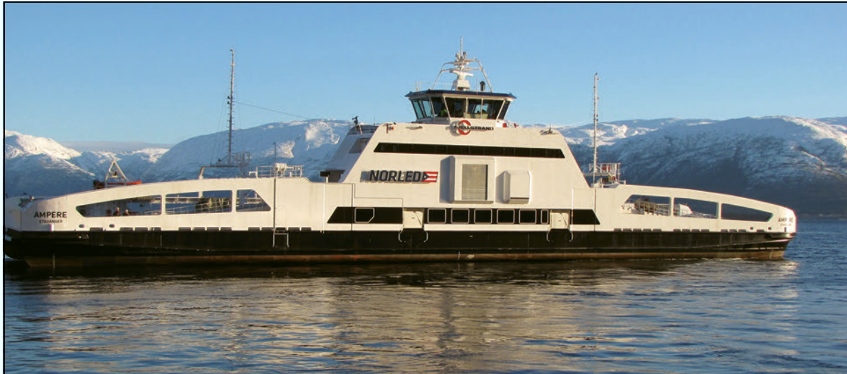
Figur 3.8 Verdas første batteridrevne ferje er norsk og heiter Ampere. Ho går i trafikk mellom Lavik og Oppedal på E39 i Sogn og Fjordane.
