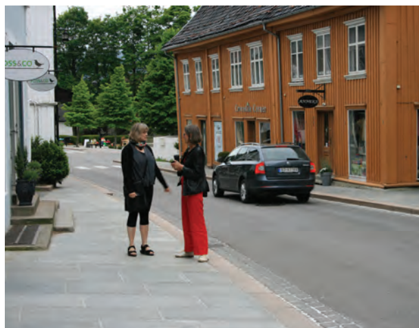
Fortauskant av platekantstein 30 cm med grå oppdalsskifer t= 5-7 cm, faste bredder 30-40-50-60-70-80 cm, fallende lengder satt i jordfuktig mørtel med spekkede fuger. Miljøgata i Drøbak. Vakre vegers pris 2002.
