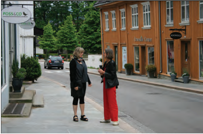
Eksempel på gate med smal kjørebane for å redusere hastighet. Miljøgata i Drøbak har kjørebane b=4,75 m og pent opparbeida fortau med oppdalsskifer. Tildelt Vakre Vegers pris 2002.
