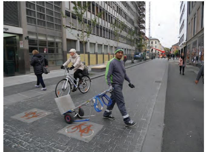
Eksempel på sykkelgate er Torggata i Oslo hvor bilen er på besøk. Kjørebanelen er 4 m med brede fortau med benker og sykkelparkering, gatetrær og kansteinsvis på 2 cm.
