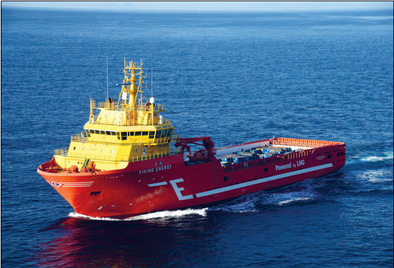
Figur 3.20 Offshorefartøyet «Viking Energy» blir bygd om til ammoniakkdrift i 2024.
