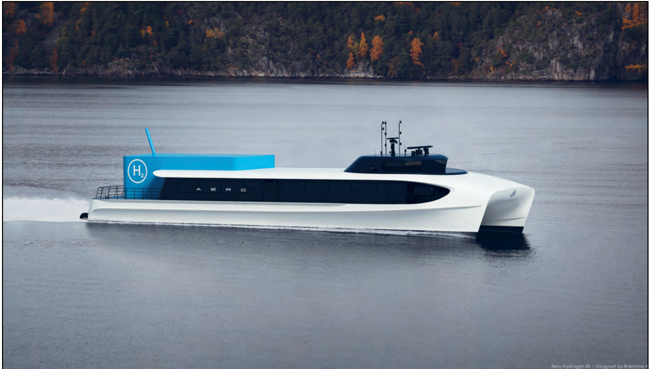
Figur 3.19 Slik kan framtidens nullutsleppshurtigbåt sjå ut. Dette er «Aero Hydrogen 40», eit konsept utvikla av Brødrene Aa i samarbeid med Westcon Power og Automation, Boreal sjø og Ocean Hyway Cluster. Båten skal kunne driftast på batteri og hydrogen, gå i 34 knop med ein motoreffekt på 2600 kW og kunne ta 277 passasjerar.
