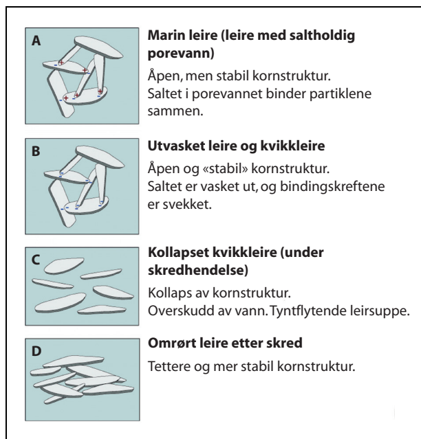
Figur 2.1 Kornstruktur i kvikkleire før og etter et skred.
