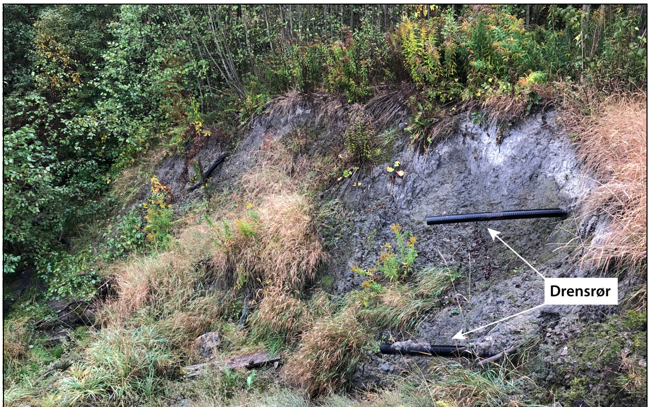
Figur 13.4 Utglidning i ravine på Romerike. NVE observerte mange erosjonspunkter i områder med jordbruksdrenering.
