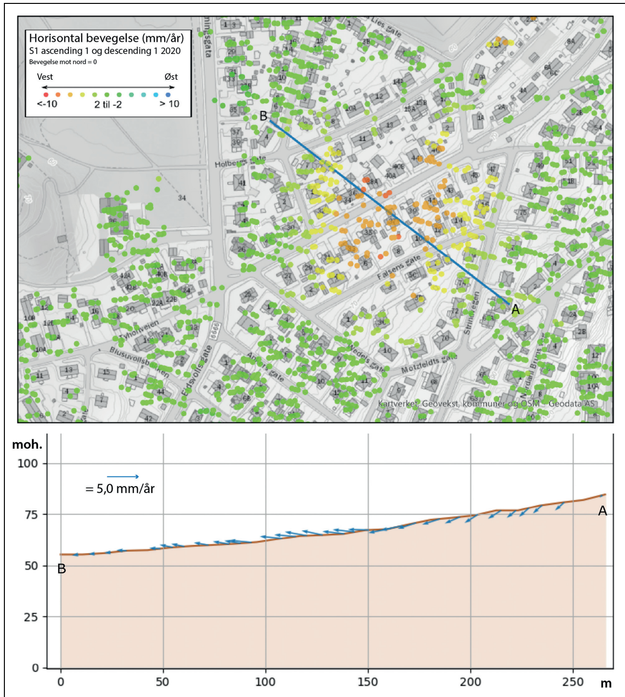
Figur 13.20 Eksempel fra InSAR-data hvor kombinasjon av to ulike datasett kan gi informasjon om horisontal bevegelse.
