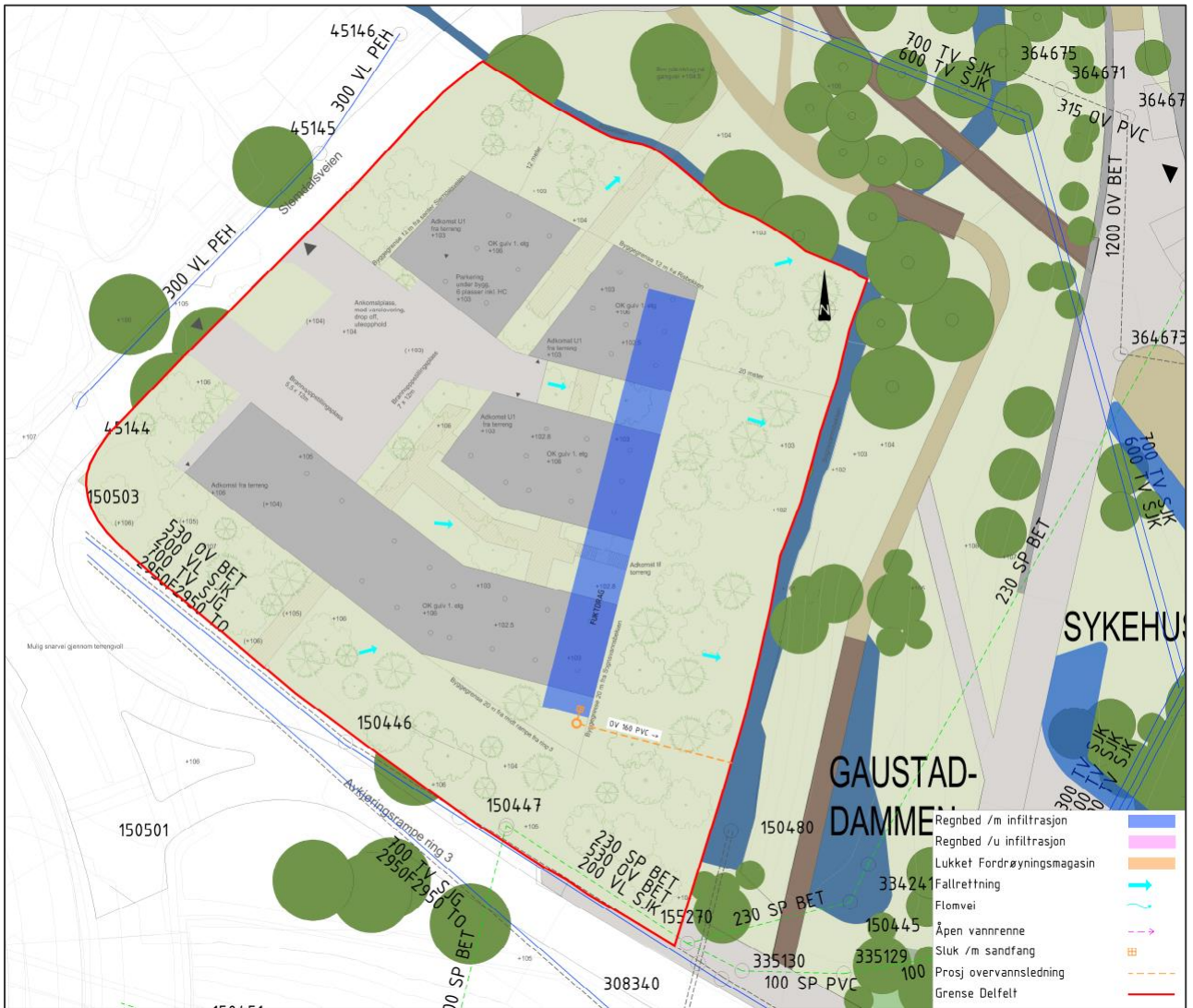
Figur 40: Konsept for overvannshåndtering for delfelt Slemdalsveien.
