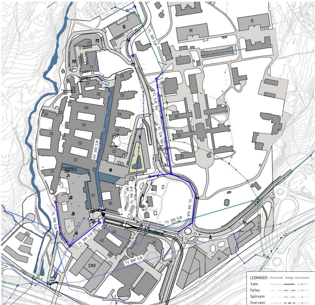
Figur 16: Planalternativ 1A: Forslag til omlegging av vannledninger. Utklipp fra vedlegg 3.
