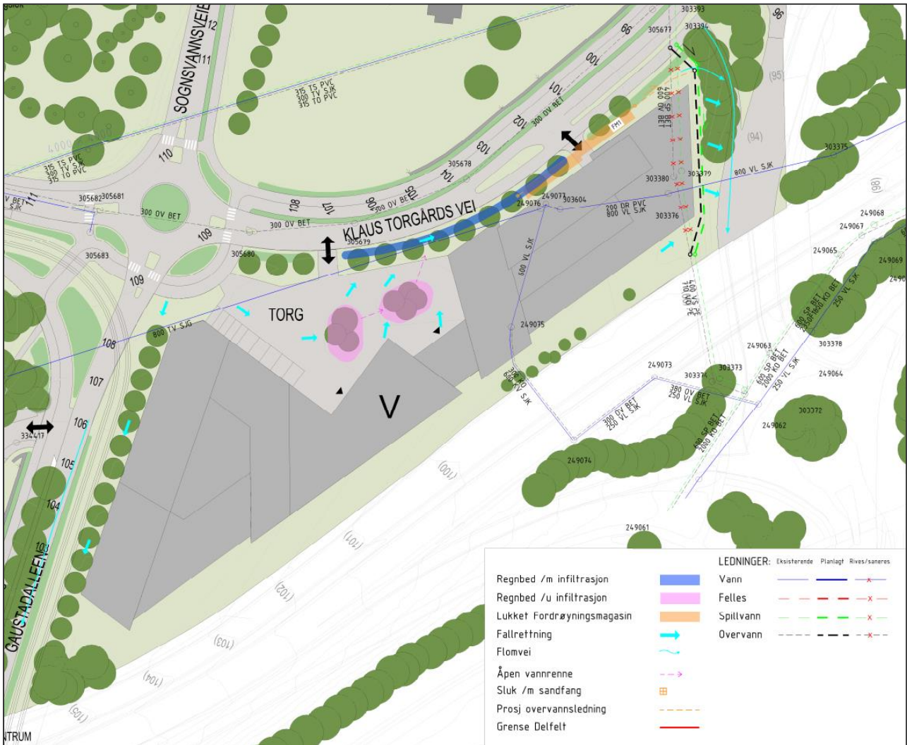
Figur 38: Konsept for overvannshåndtering for delfelt bygg V.
