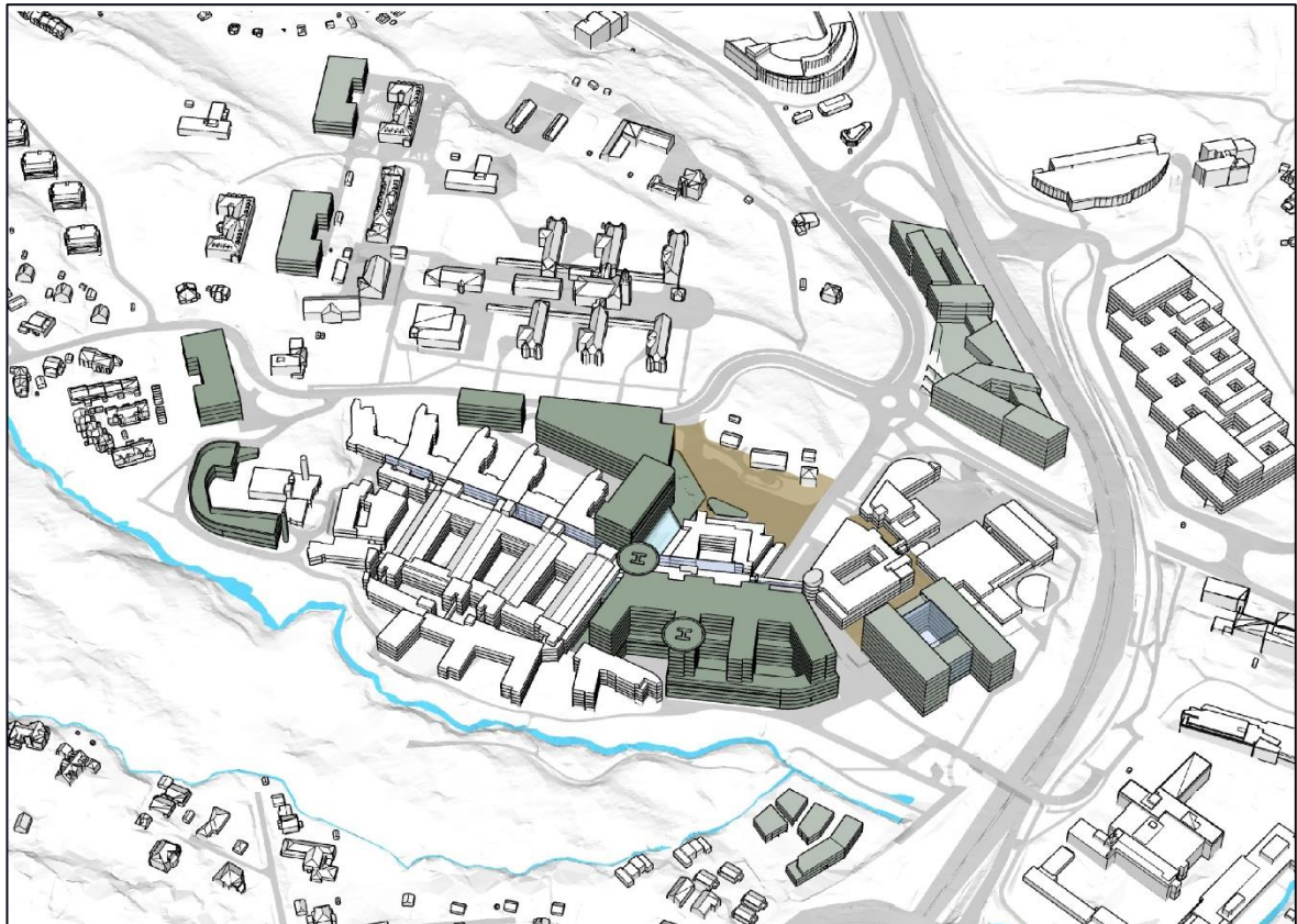
Figur 9. Volumstudie. Mørkegrønne volumer er arealer for etappe 1, lysegrønne volumer er arealer avsatt for utvikling i etappe 2. Nytt atkomstorg er markert i brun. Planalternativ 1B (himmelretning mot øst).
