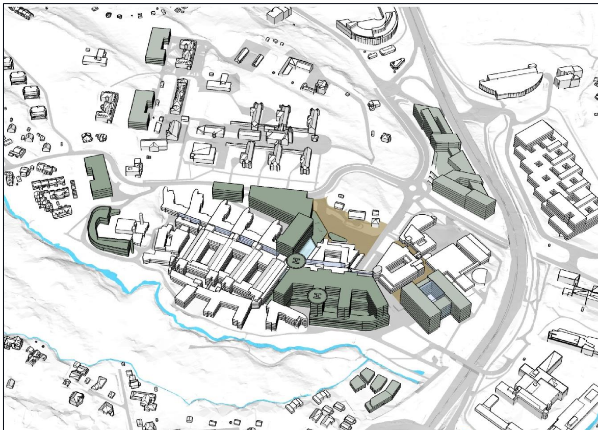
Figur 15. Volumstudie. Mørkegrønne volumer er arealer for etappe 1, lysegrønne volumer er arealer avsatt for utvikling i etappe 2. Nytt atkomststorg er markert i brun. Planalternativ 1B (himmelretning mot øst).
