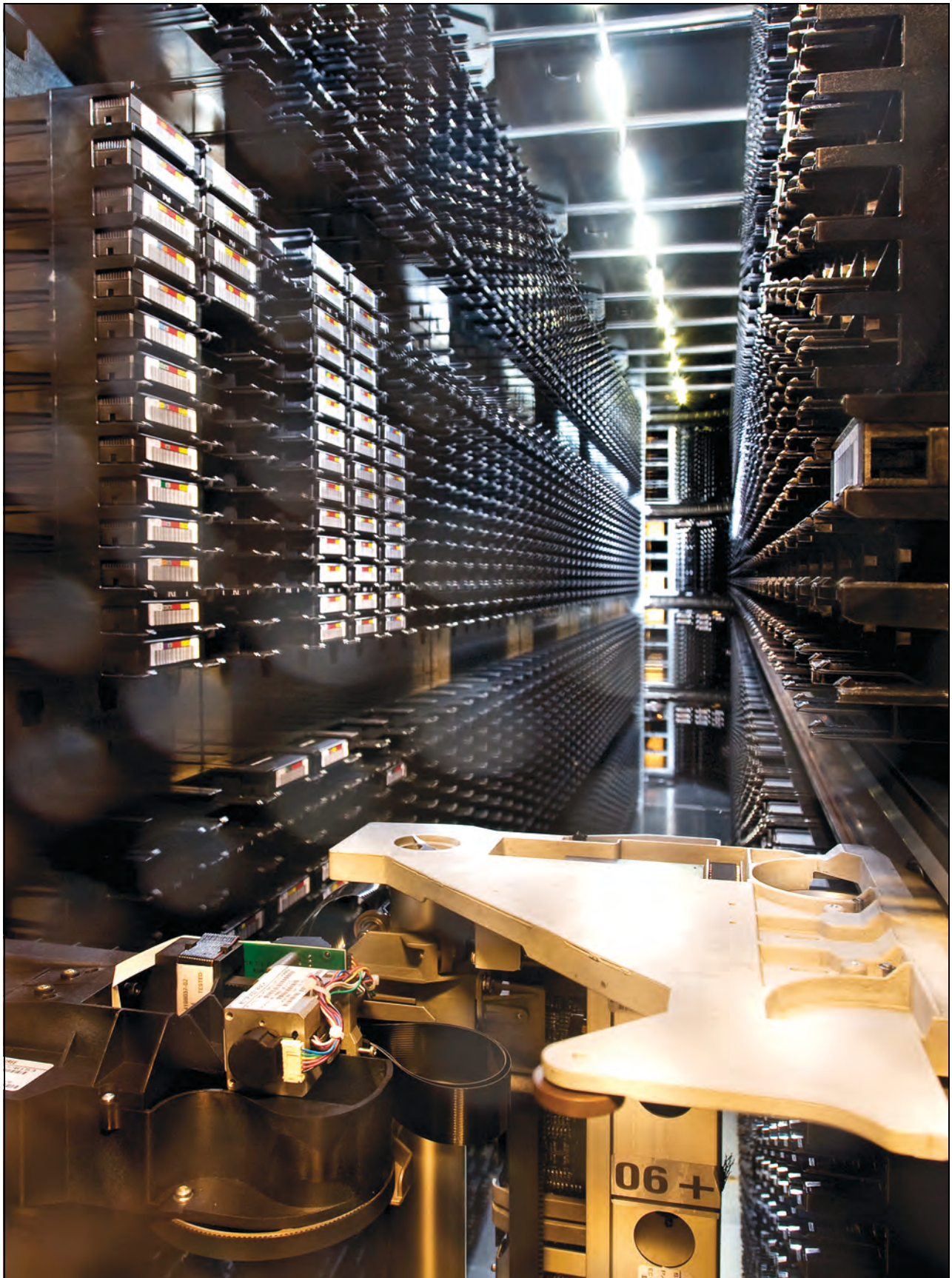
Figur 5.2 Ein teiprobot frå Nasjonalbibliotekets digitale sikringsmagasin. Alt blir lagra i tre instansar – servere og to teiprobotar, som alle er plasserte i tre forskjellige rom.
