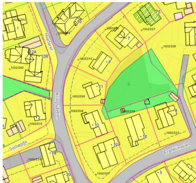
Figur 20 Eksempel på reguleringsplan der det som er bygget ikke stemmer med planen.
