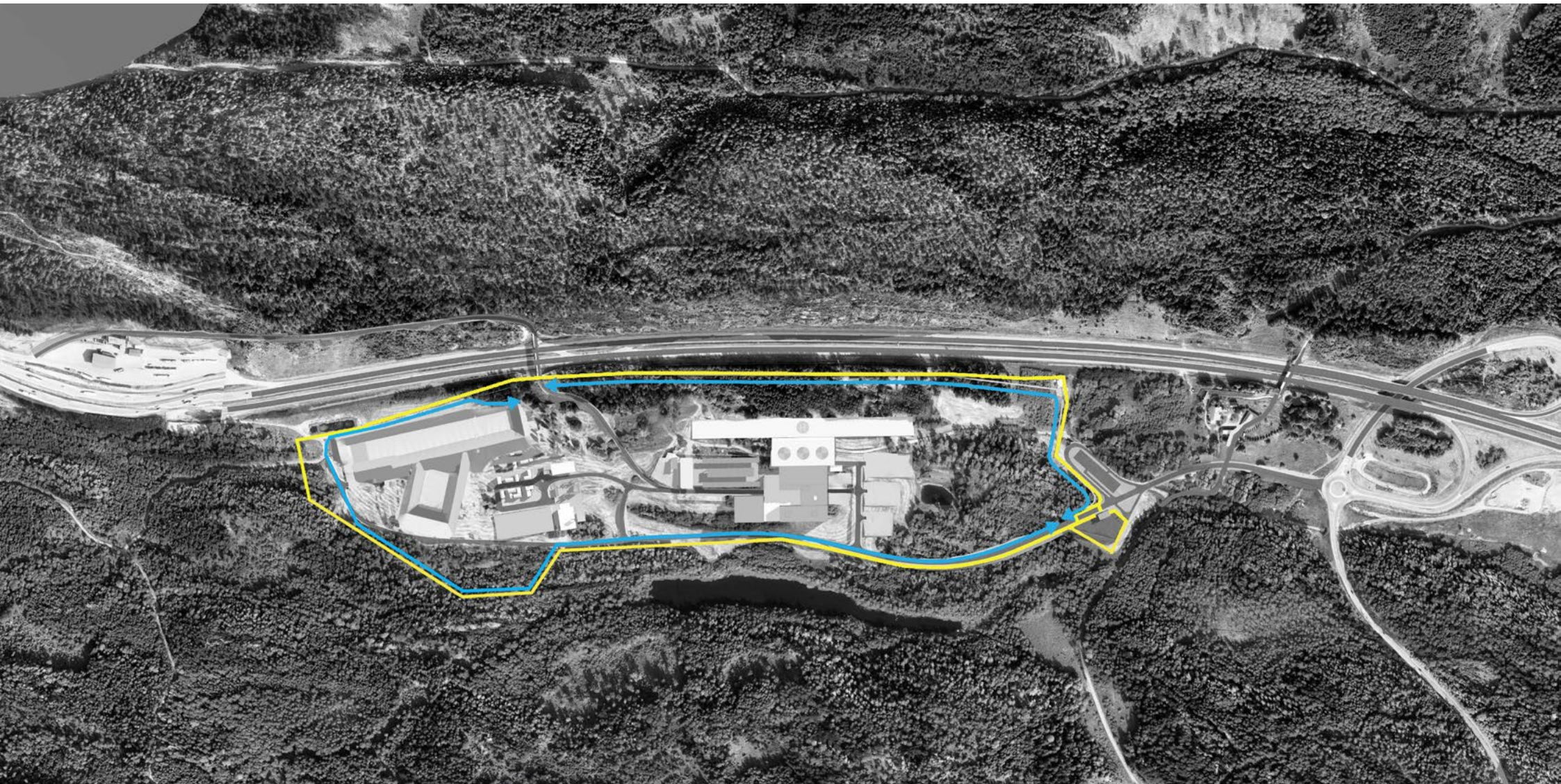
Figur 9: Perimetersikring rundt anlegget. (Nord er til venstre på figuren). Gul linje markerer gjerdet rundt beredskapssenteret. Gjerdelinjen er regulert i plankartet. Blå linje viser inspeksjonsvei som anlegges innenfor gjerdet.
