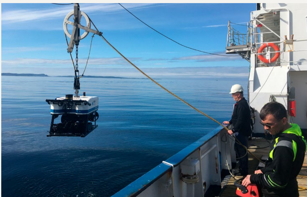
Den fjernstyrte undervannsfarkosten blir sjøsatt fra MS Hydrograf. Etter ca. 45 minutter er den nede på 500 meters dyp og kan starte kartleggingen.
