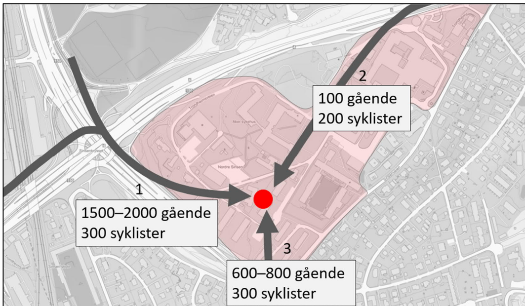
Figur 8 : Tre hovedakser. Estimert antall gående og syklende per time i fremtidig situasjon. Nye Aker er angitt i rødt. Rød sirkel viser omtrentlig plassering av hovedinngang
