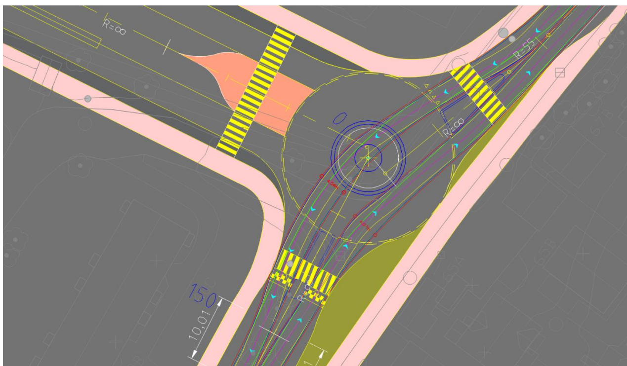
Figur 2: Sporing Vogntog (rødt=speil, blått=kropp, grønt/gult=hjul)
