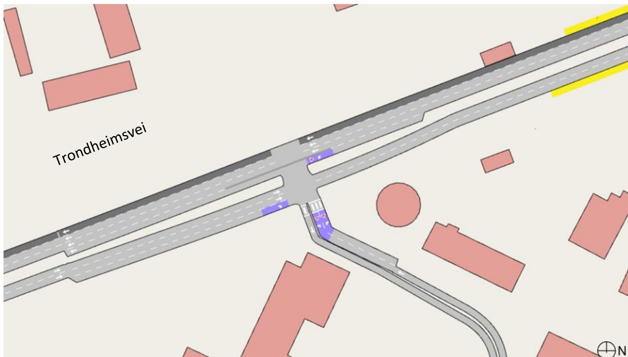
Figur 76 Løsning med signalregulert T-kryss med venstresvingefelt (Rambøll, 2021).
