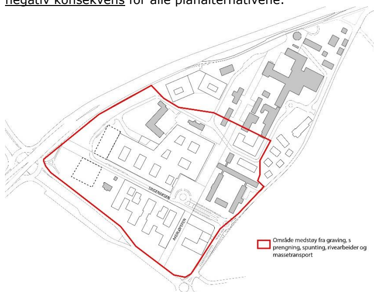
Figur 16. Område med mest støyende anleggsaktivitet. Gjelder utbygging i etappe 1 i planalternativ 1A og 1B.
