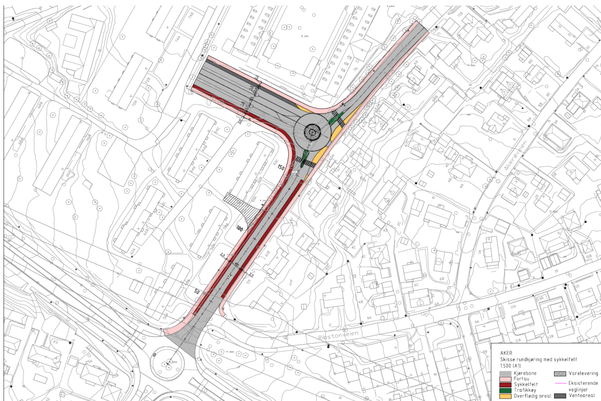
Figur 12: Alternativ 2 - Rundkjøring med sykkelfelt
