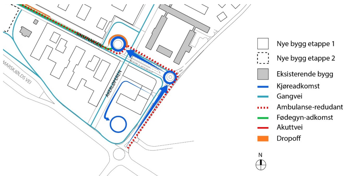
Figur 22. Flyttdiagram for trafikkløsning hovedadkomst fra Sinsenveien (Team Aker, 2021)
