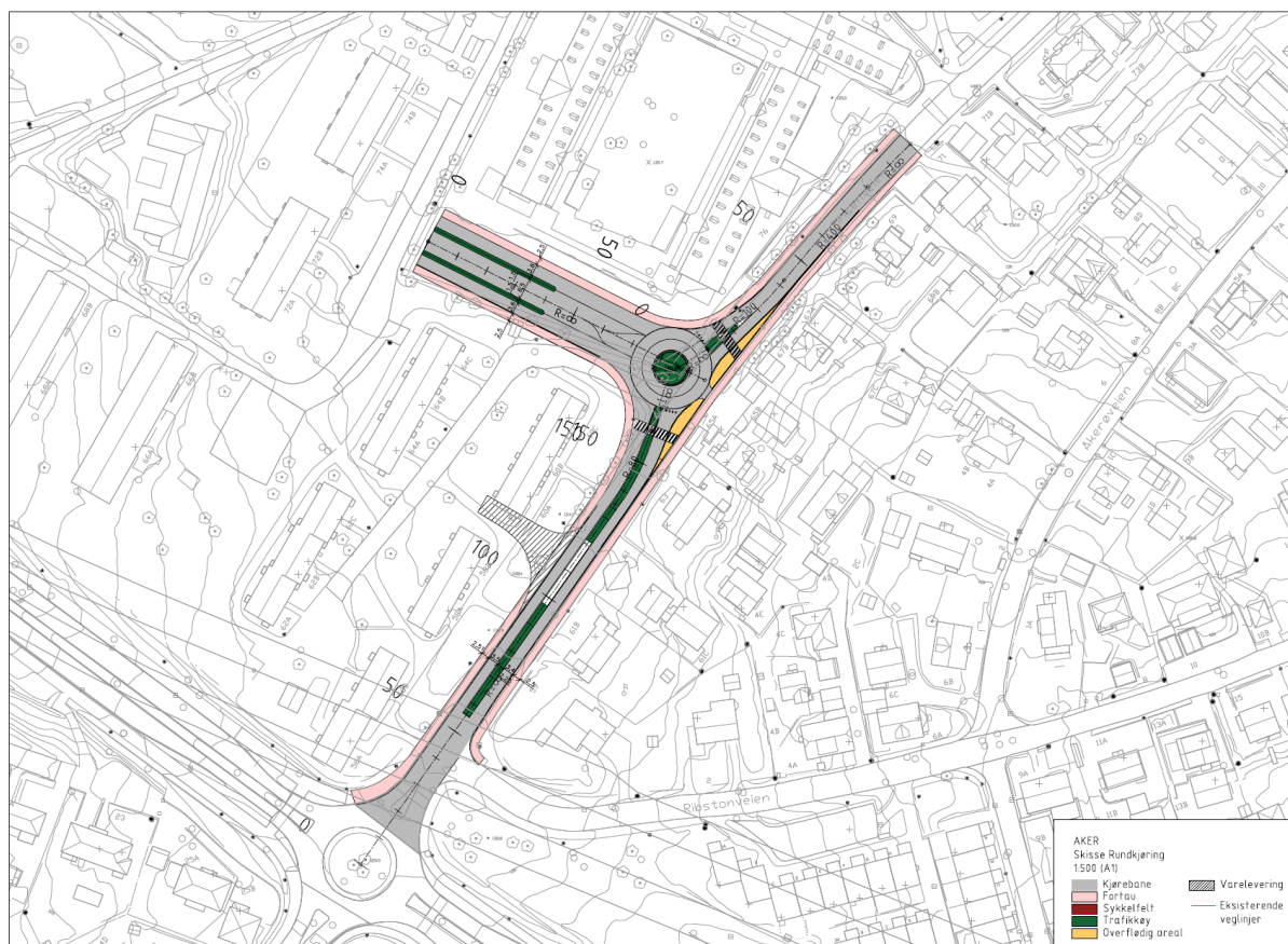
Figur 13. Alternativ 3 – Rundkjøring uten sanering, med midtrabatt og fortau
