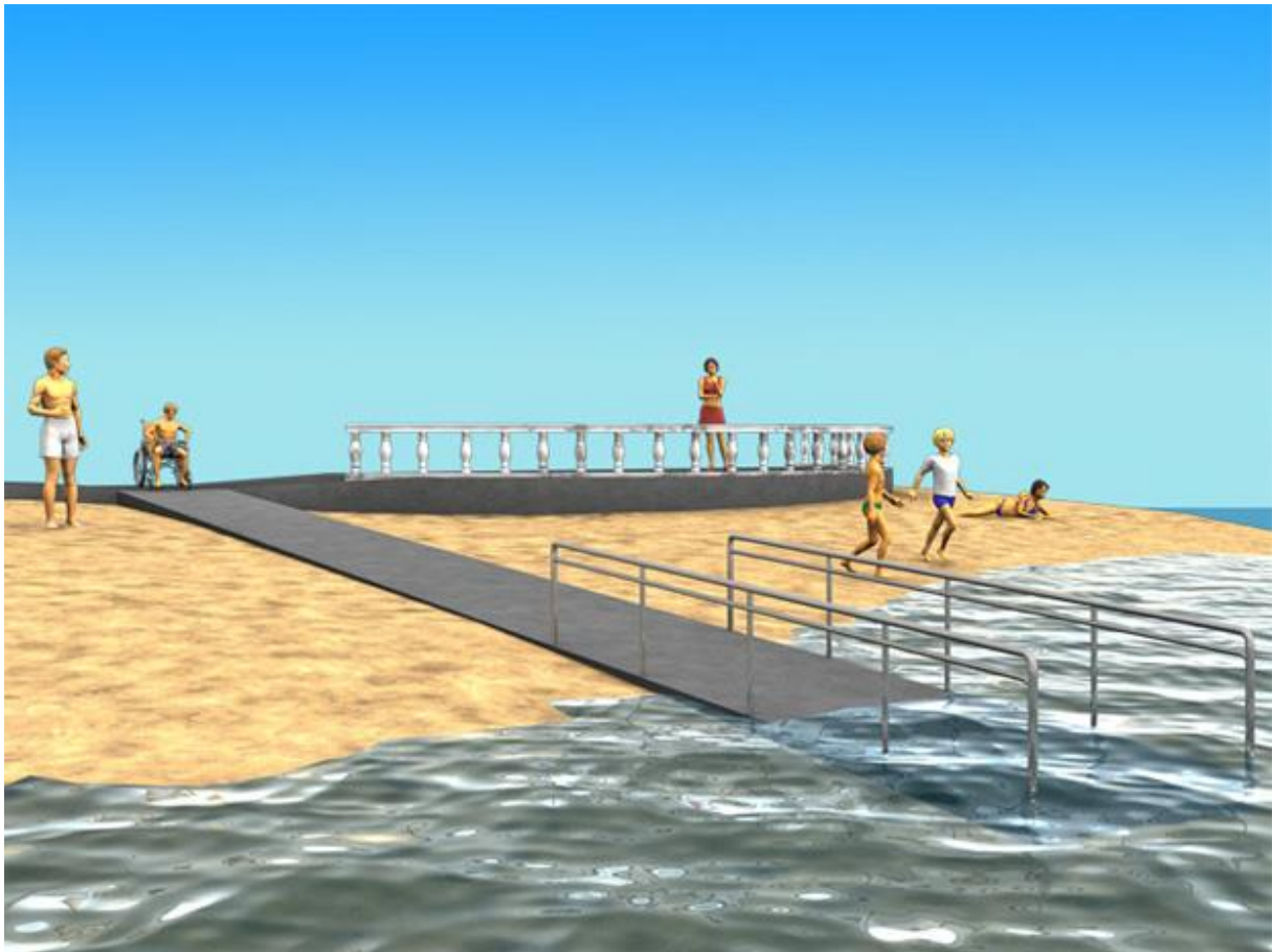
§ 8-3 Figur 2: Badeplass som er utformet slik at det er lett å komme seg ned i og opp av vannet.
